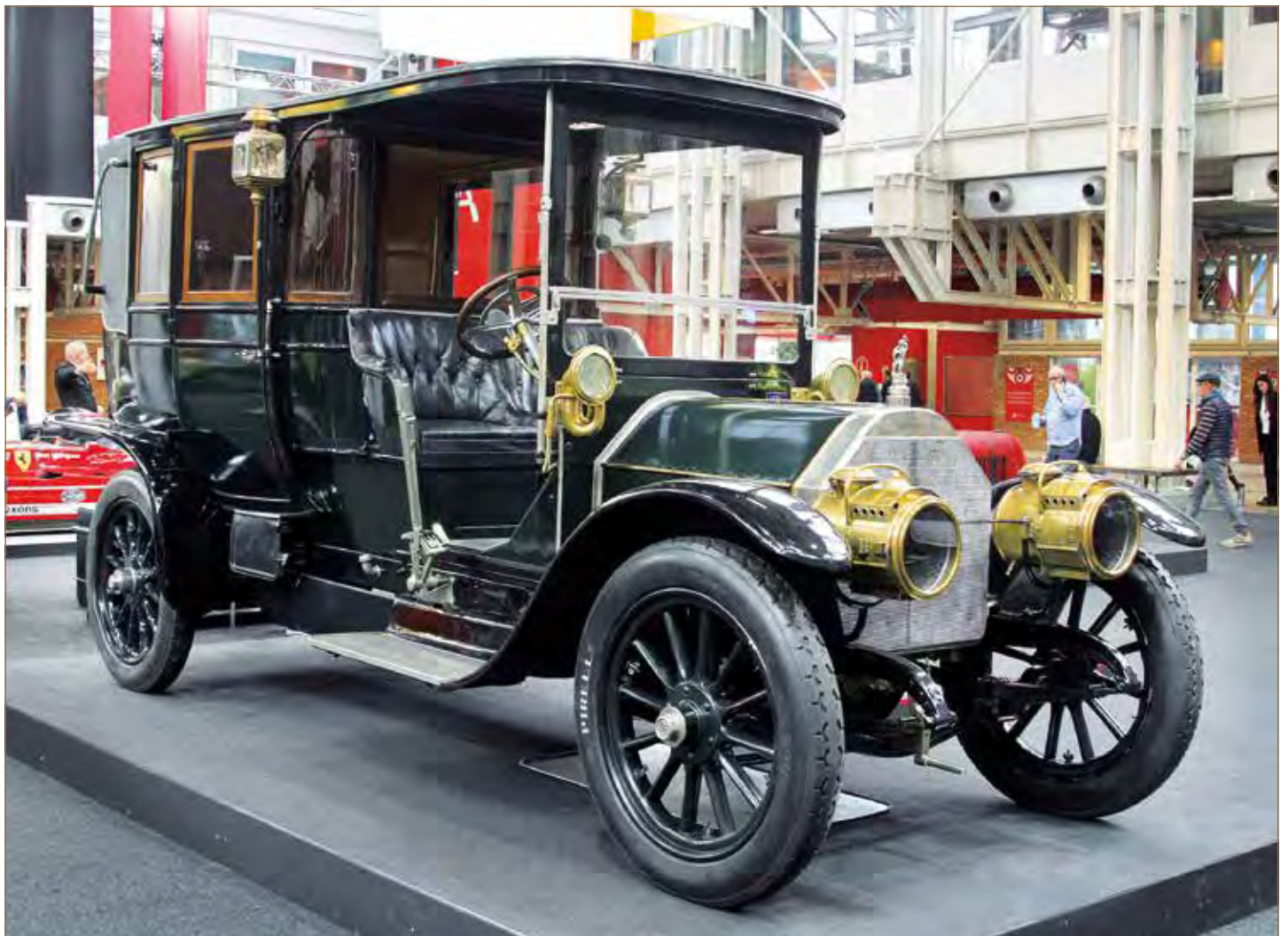
▲ Een van de Fiats die door het Turijnse museum werd tentoongesteld was een 35/45 met de naam "Palombella": een luxueuze landaulet met carrosserie van Cesare Sala uit Milaan voor koningin Margaretha van Savoye. Het chassis is dat van de Itala "Peking - Parijs" uit 1907, licht aangepast, in het bijzonder met twee aparte rempedalen
