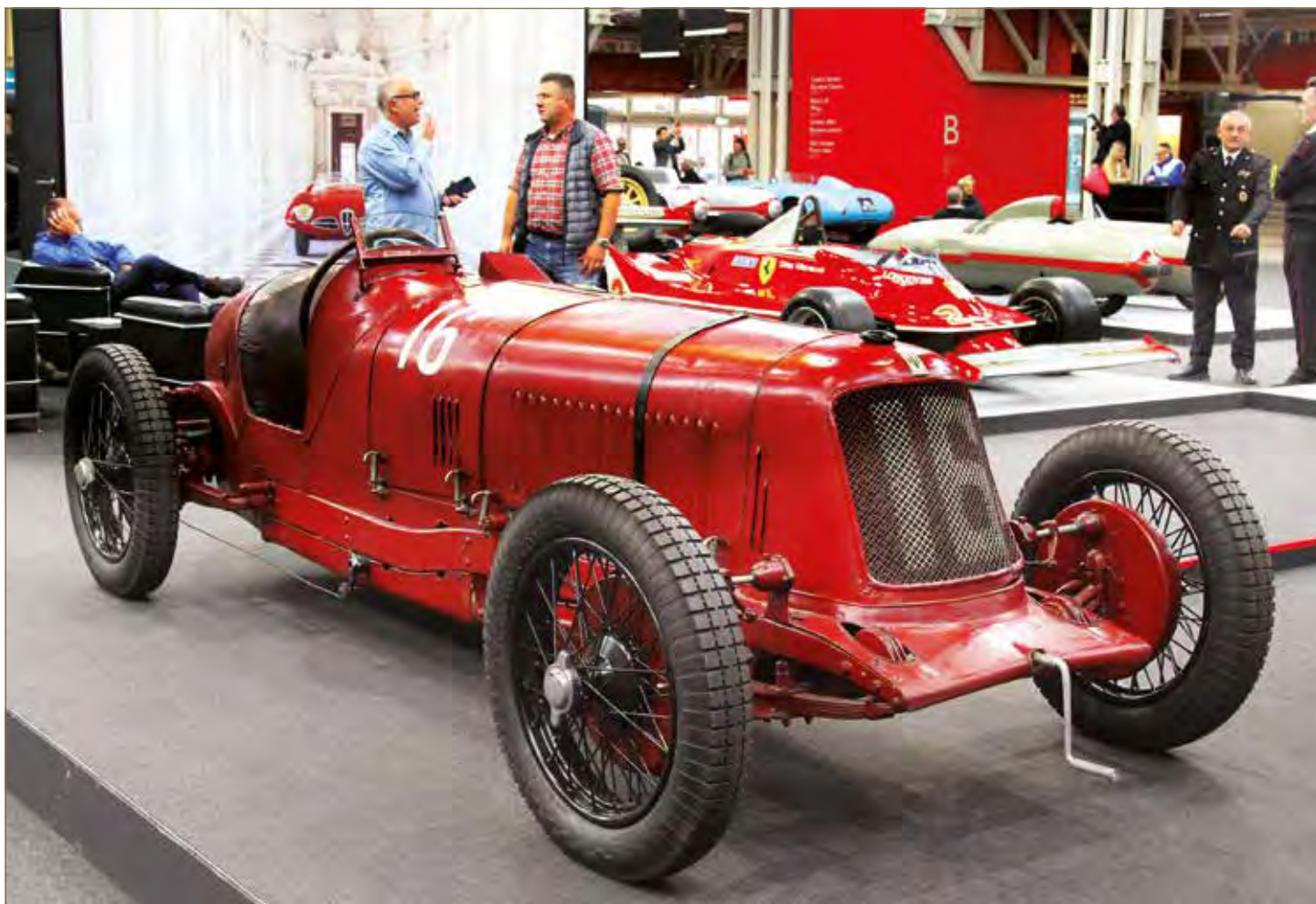
Deze Maserati 26 B uit 1928 begon zijn sportieve carrière met een 3 e plaats in de Targa Florio in 1927, bestuurd door Alfieri Maserati. 8-cilinder motor, 1980 cm 3 , 155 pk en 180 km/u
