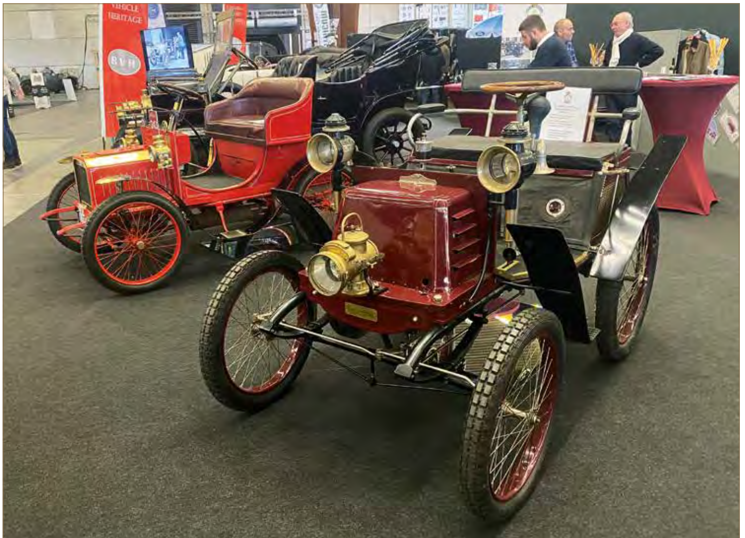
▲ Een Brusselse Vivinus “voiturette” uit 1899 met een luchtgekoelde ééncilinder van 708 cc en met 3,5 pk. Daarnaast een Antwerpse Minervette uit 1904 met watergekoelde 636 cc van 5 pk
