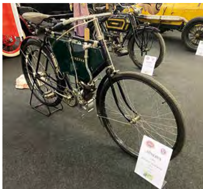
▼ Minerva fiets met "clip-on" motor van 211 cc en 1,5 pk
