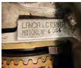
Je terminerai par un exemple tiré de ma propre expérience. Il y a deux ans, le bloc moteur en aluminium de ma Lancia Lambda, alors âgée de 95 ans, s'est fissuré. En Italie, Storicar fabrique des blocs flamboyants neufs, fraisés à partir d'un bloc d'aluminium massif. Le jour où j'en ai commandé un, on m'a platement demandé quel numéro inscrire dessus. J'ai choisi le même que celui de l'ancien moteur. "Matching Numbers", vous dites?
