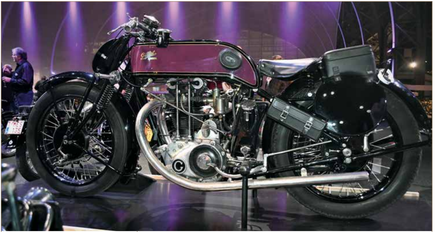
Encore une bête de compétition unique de 1929 : moteur 600 cc, course de 107 mm, couronnée de succès à Montlhéry.
