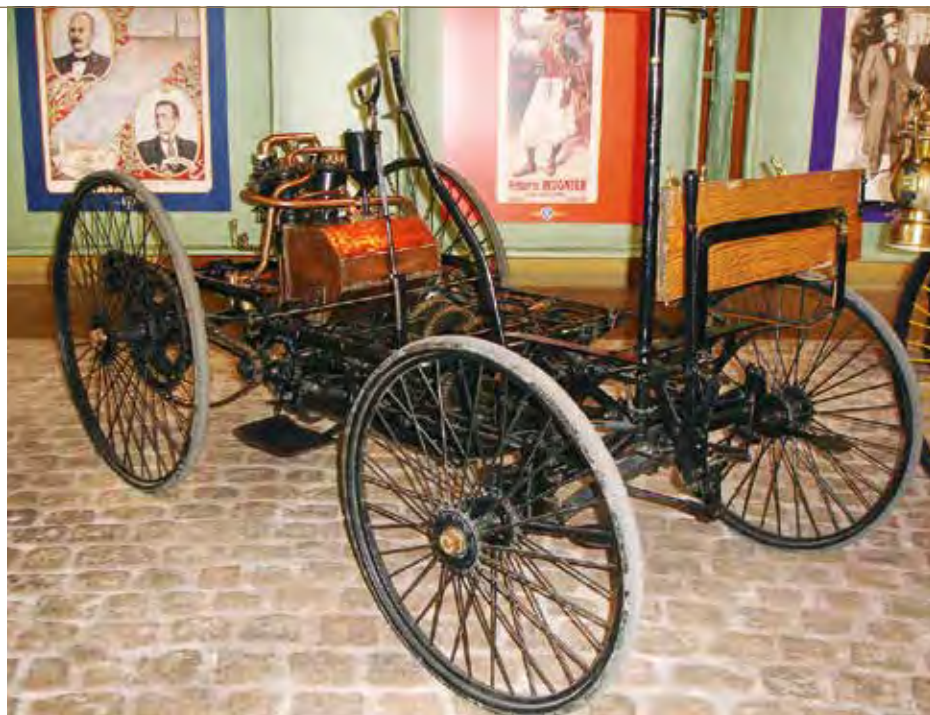
Een experimenteel chassis uit 1891-94 waarin de invloeden van de fietsproductie nog zichtbaar zijn. Tweecilinder Daimlermotor met een grote koperen waterketel die is aangesloten op het buizenchassis, dat zo ook dienst deed als radiator.
