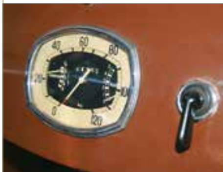
Combiné d'instrument avec jauge à carburant et manomètre de pression d'huile
