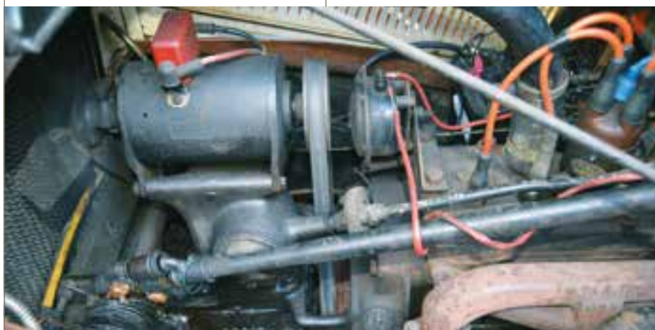
Coup d'œil sous le capot. La boîte de vitesse est à l'avant et la dynamo – qui entraîne aussi le ventilateur – est montée juste au-dessus
