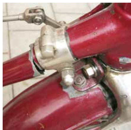
Rupture de châssis... La fatigue du métal n'est pas anormale sur un véhicule vieux de près de 120 ans.
