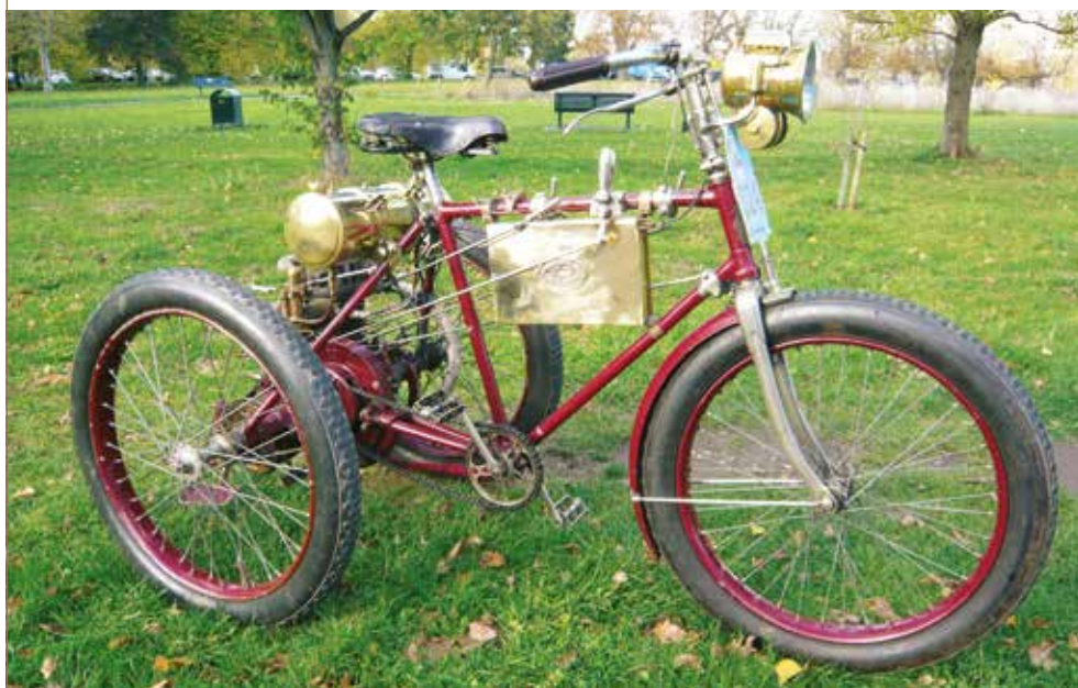
La machine est primitive, mais dispose tout de même d'un embrayage et d'une boîte 2 rapports optionnelle.
