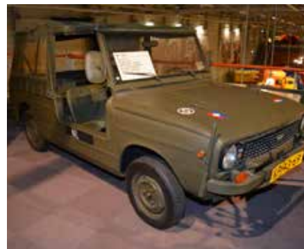
In 1974 bestelde het Nederlandse leger 1.200 auto's op basis van de DAF 66. Krachtbron was een viercilinder Renaultmotor met 1289 cc, zoals op de gewone 66. In tegenstelling tot wat men zou vermoeden, hadden deze legerauto's geen vierwielaandrijving.
