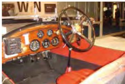
Tableau de bord d'une Bentley 3 litres de 1923. Le tripmaster à gauche ne faisait pas partie de l'équipement de base.
