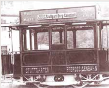
De eerste tram van Daimler uit 1888, de motor had het paard vervangen. Blijkbaar vond niemand de gelegenheid om het oude opschrift 'Pferdeisenbahn' (pardentram) te verwijderen.
