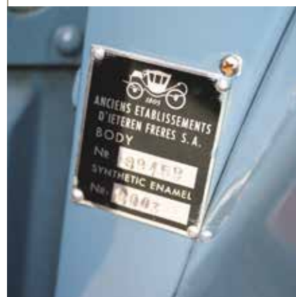
Identificatieplaatje in linker deurstijl
