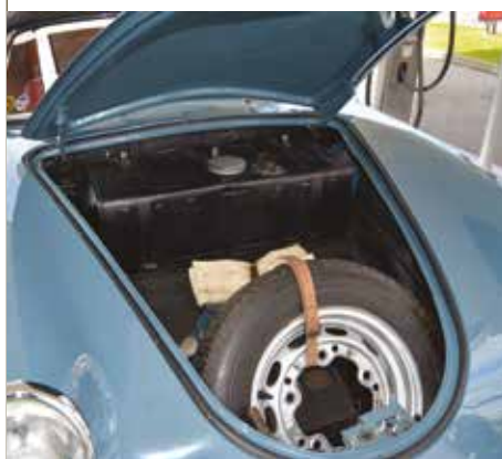
Pour accéder au réservoir, il faut ouvrir le capot de coffre. Et il ne reste guère de place pour le reste.
