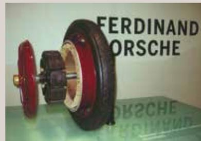
Comme Porsche avait au départ une formation d'électricien, il proposa logiquement une voiture électrique, propulsée par deux moteurs électriques de 2,5cv situés dans le moyeu de chacune des roues antérieures. Bien vite, afin d'améliorer la faible autonomie, il se rendit à l'évidence que, pour éviter d'ajouter des batteries ce qui pénalisait le poids, il fallait mieux produire de l'électricité par une génératrice connectée à un moteur Daimler à essence.
