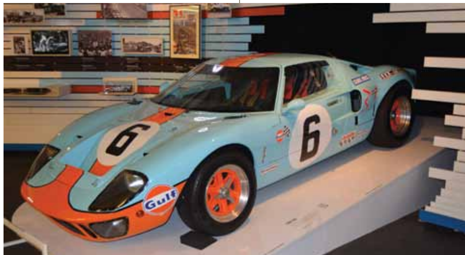
Ford GT40 24h Le Mans 1969, 338km/h, 4.942cc, 440cv (Collection Guy De Baer)
