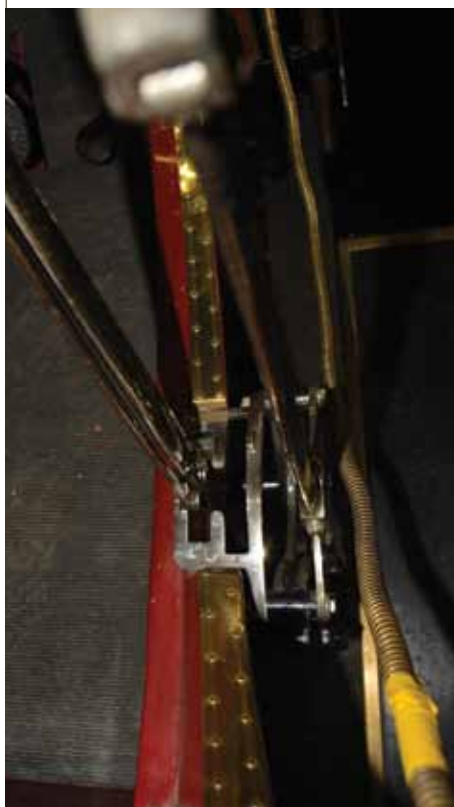
De schakelgrille met net daarnaast de handrem, die op de transmissie ingrijpt.
