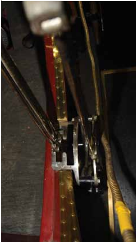
La grille de changement de vitesse, et juste à côté le frein à main, qui agit sur la transmission.
