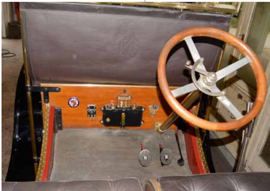
La planche de bord brille par sa simplicité. Au centre, les témoins de lubrification, à droite le logo Nagant. Le levier sur le volant sert à régler l'avance à l'allumage.
