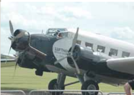
Junkers 52, eigendom van Lufthansa, met drie BMW-stermotoren.
