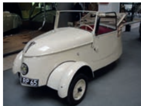
Durant la seconde guerre mondiale, Peugeot était comme bien d'autres marques à la recherche d'une petite auto bon marché. Et en raison de la pénurie de carburant, on s'intéressa à l'électricité. Cette VLV date de 1941. On dirait un engin à trois roues, mais on trouve bien une double roue à l'arrière, entraînée par un moteur électrique de 3,5 ch. L'autonomie était de 5 heures. 377 exemplaires de cette petite voiture furent produits, et étaient entre-autres utilisés par la Poste.
