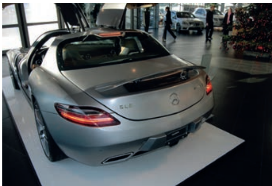
De afgeronde achterkant van de SLS is voorzien van LED verlichting en een vleugel die zich bij 120 km/u ontplooit.
