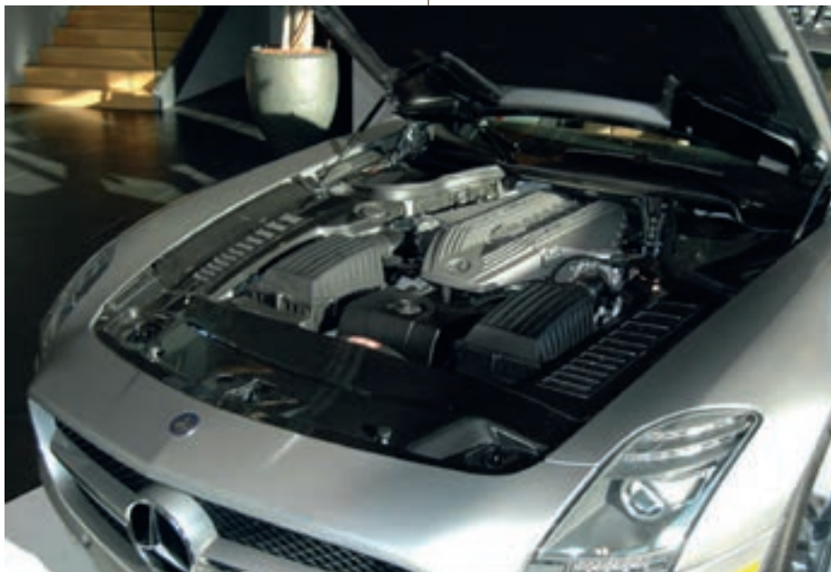
De motor, typenaam M159 weegt slechts 205 kg. Hij heeft een droge carter, zodat hij laag en ver naar achter kon worden ingebouwd.
