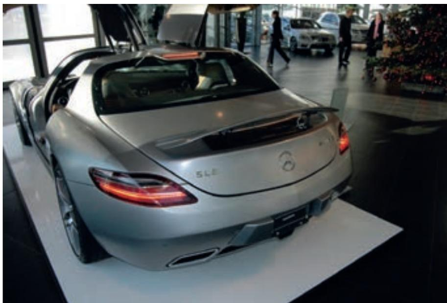
*Le postérieur arrondi de la SLS est pourvue de lampes LED et d'un aileron qui se déploie à 120 km/h.*
