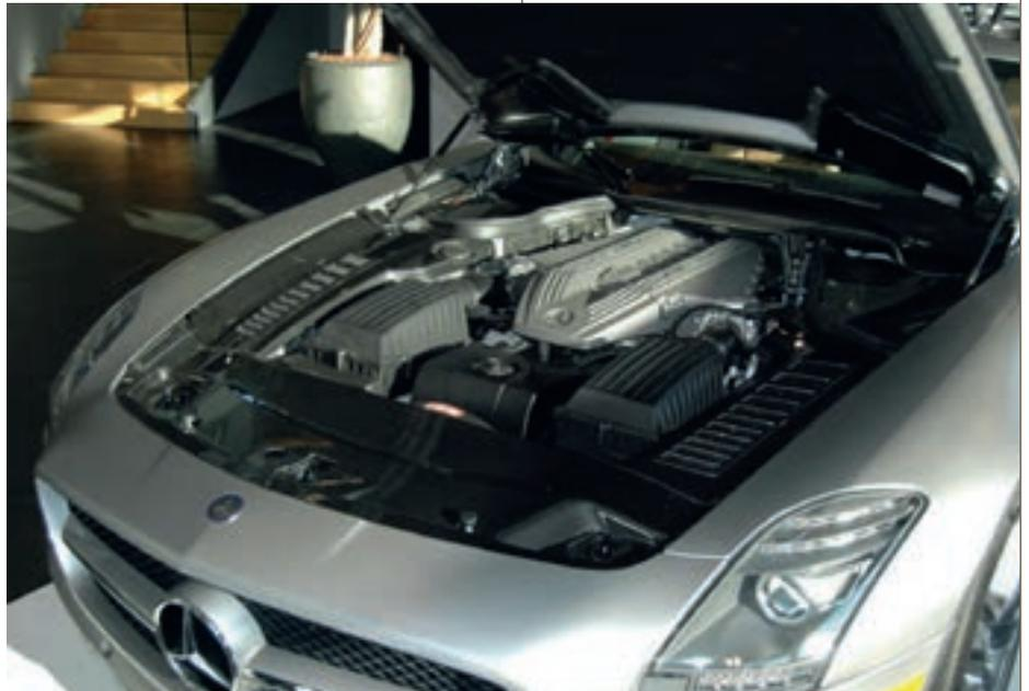
*Le moteur, type M159 ne pèse que 205 kg et est à carter sec, de qui permet de le placer bas et loin vers l'arrière.*
