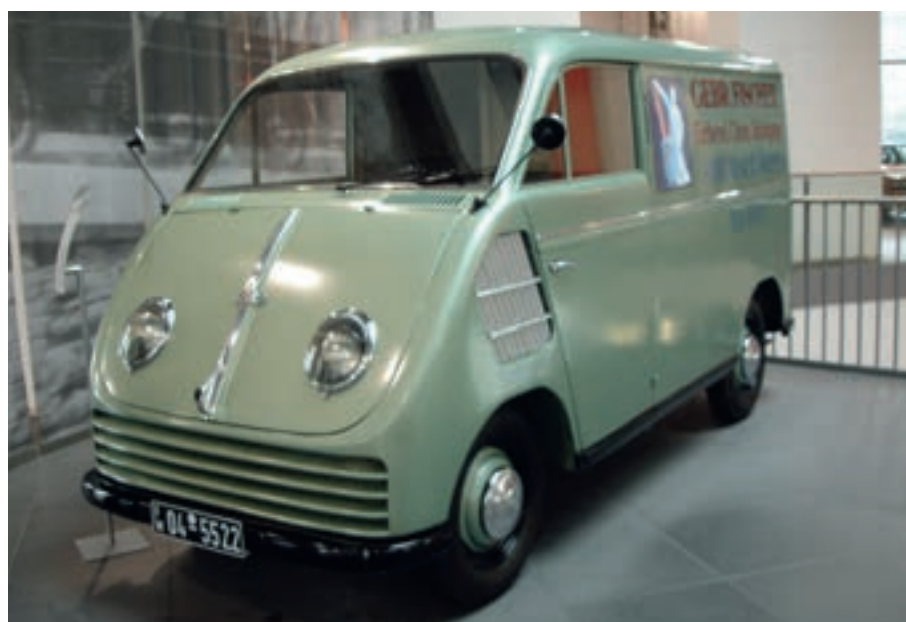
DKW F 89 L Schnellaster (1949 – 1954), de eerste Auto Union van na de IIde Wereldoorlog en de eerste auto die in Ingolstadt werd geproduceerd. Een intelligent ontwerp met voorwielaandrijving en uitgekiende laadruimte.
