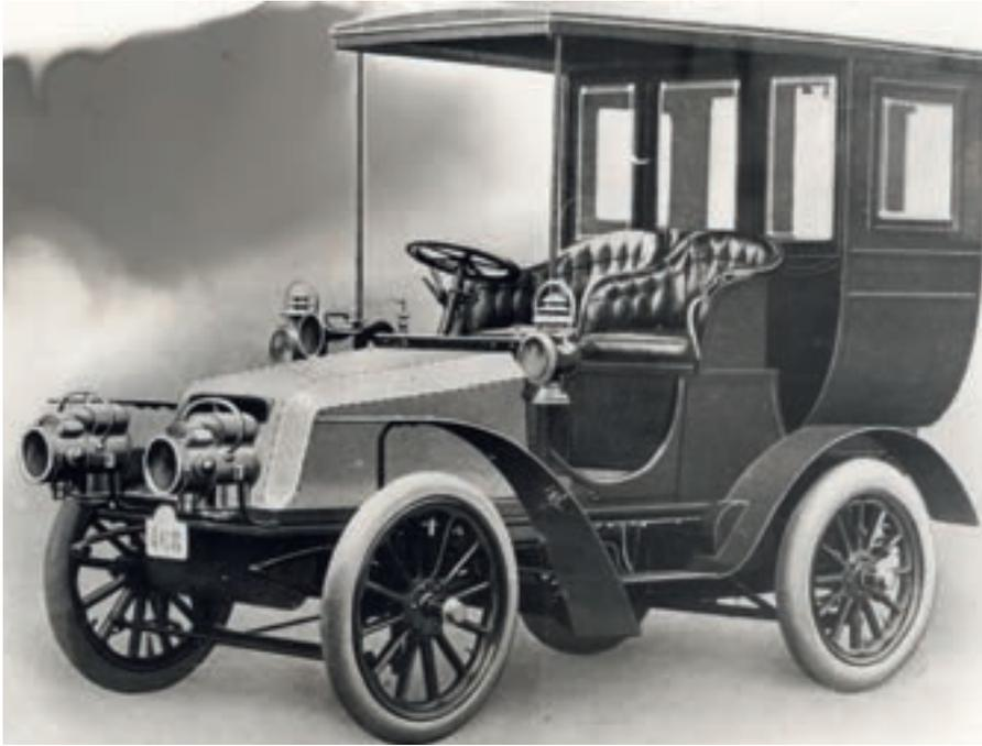
ment orientée vers les véhicules à pétrole: un 4 cyl. de 24 cv (100 x 120) à soupapes latérales et transmission par cardan et un 6 cyl. de 60 cv aux mêmes cotes puis en 1908 une nouvelle "type D" à moteur 4 cyl. monobloc de 30 cv disposant d'un vilebrequin à cinq paliers dont la robustesse fera le succès et sera utilisé comme taxi tant à Bruxelles que dans d'autres villes du pays.
